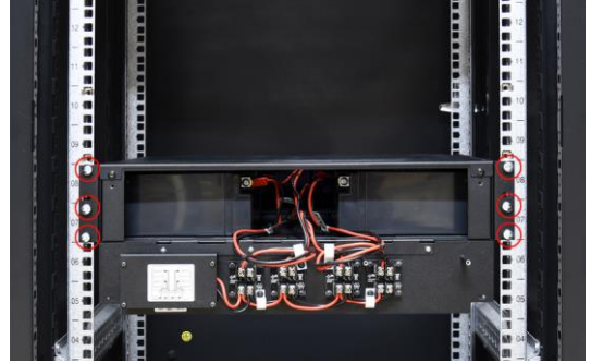
Rys. 4 Sposób wsunięcia akumulatorów.
